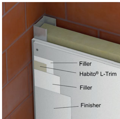
Creëren van schaduwvoeg met Habito® L-Trim (voor plaatdikte 12,5 mm).
