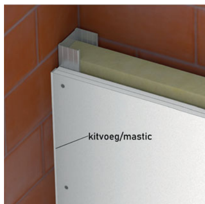
Rechte opening (Max. 2 à 4 mm) dichten met elastische kit.
