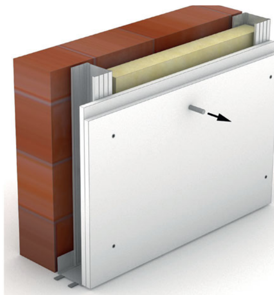
Lichte voorwerpen kunnen met holle wandpluggen aan de Gyproc® plaat worden bevestigd.
