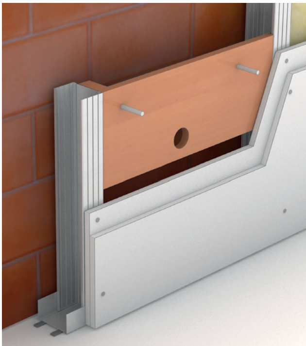
Sanitaire apparaten worden aan ingebouwde hulpconstructies bevestigd.
